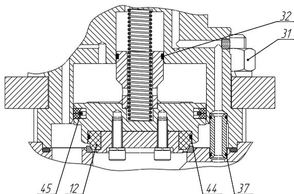
Рис. 1в. Клапан СЕНС ПУ (DN80). Общий вид.
