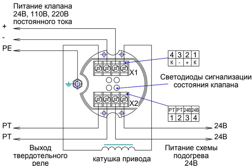
Рис. 5б Модуль-СФУ-12/24В, 110/220В постоянного тока. Схема подключения
